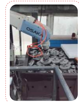
● 大负载六轴机器人3D视觉无序抓取上料
