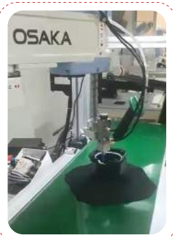
● SCARA四轴机器人视觉在线追踪点胶
